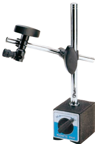
Supporto portacomparatore magnetico a chiavetta , base magnetica con superfici di appoggio piana e a V, attacco comparatore Ø 8 mm, forza trazione 60 kg, raggio d'azione 340 mm.
