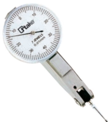
Tastatore a leva in acciaio cromato opaco, attacco a codolo a coda di rondine, campo di misura 0,8 mm., diametro 38 mm., risoluzione 0,01 mm.
