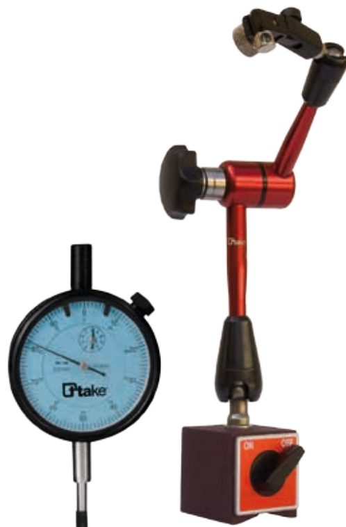
Kit supporto magnetico snodato porta comparatore (forza trazione 80 kg, raggio d'azione 340 mm), completo di comparatore di precisione (Ø 58 mm, corsa 10 mm, risoluzione 0,01, scala circolare 0÷50÷100), con puntalino in ceramica.
